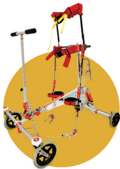
«ЭкзоБот 3» предназначен для детей ростом 130 – 180 см и массой до 80 кг.
