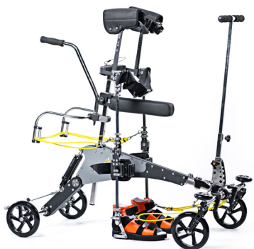
ЭКЗОБОТ 3 предназначен для детей ростом 130 – 180 см и массой до 80 кг.
